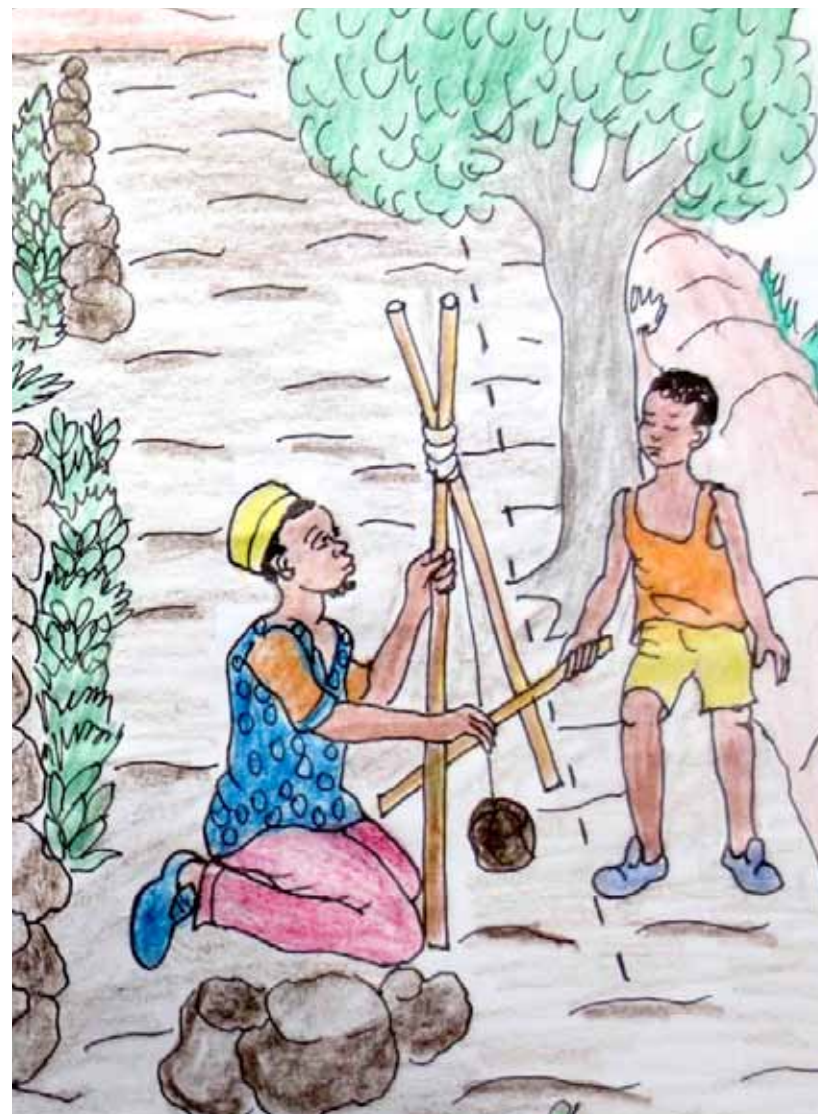
traçage des courbes de niveau avec «le triangle en A» / dessin: Ouedraogo
